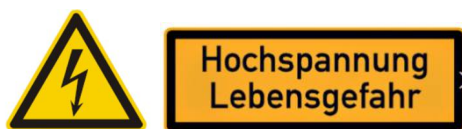
Abb. Kennzeichnung elektrische Betriebsräume > 1kV
