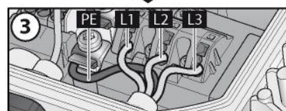
Abb. 3: Anschluss der Leitungen an Klemmen
