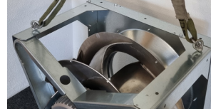
Montage von Hebeösen an dafür vorgesehenen Stellen
