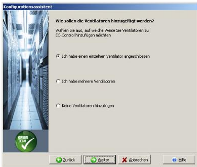
Abb. 3-12 Hinzufügen von Ventilatoren zu einer Großanlage
