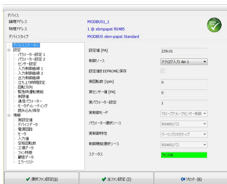
図 62：差圧 225 Pa、ポテンショメータ経由の設定値入力の場合のアナログ入力
